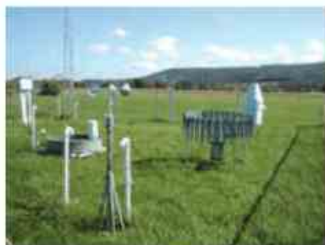
در ایستگاه‌های هواشناسی با استفاده از انواع ابزارها، میزان دما، بارش، رطوبت، سرعت، جهت و وزش باد و... به طور دائم ثبت می‌شود.
