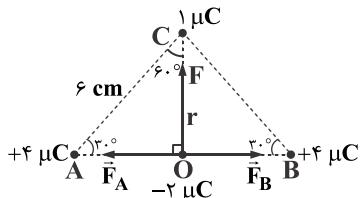
دو بردار  $F_A$  و  $F_B$  هم اندازه، در یک راستا و مخالف جهت یکدیگرند، بنابراین یکدیگر را خنثی می‌کنند، بنابراین  $F_T = F = F_T$ ، از طرفی ضلع روبروی زاویه  $30^\circ$  در یک مثلث قائم‌الزاویه برابر نصف وتر است؛ یعنی  $CO = 3 \text{ cm}$ .
