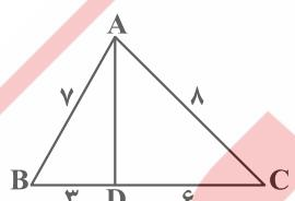
قضیه استوارت:  $AB^2 \times DC + AC^2 \times BD = AD^2 \times BC + BD \times DC \times BC$
