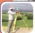
نقشه بردارها به کمک دوربین مخصوص نقشه برداری، طولها و زاویه های مختلف را اندازه گیرند. سپس اطلاعات جمع آوری شده را در اختیار مهندسان عمران قرار می دهند تا از آن برای طراحی و محاسبه های مورد نیاز در ساخت بناهای مختلف از جمله، ساختمان، جاده و سیل بند استفاده کنند.
