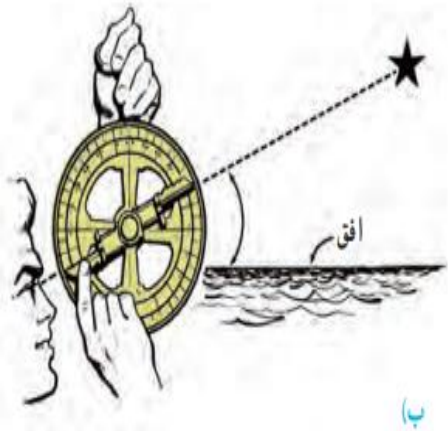
شکل ۱- الف) اسطرلاب، ب) نحوه رصد ستاره به وسیله اسطرلاب
