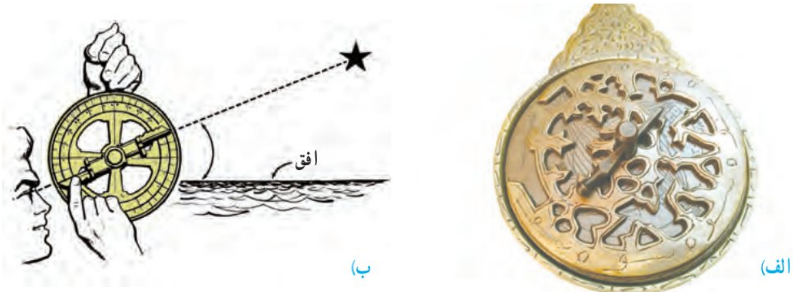
شکل ۱- الف) اسطرلاب، ب) نحوه رصد ستاره به وسیله اسطرلاب
