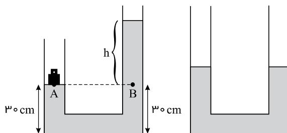
بعد از برداشتن وزنه، ارتفاع مایع در دو طرف لوله یکسان می شود. پس اگر مایع در لوله سمت چپ به اندازه  $x$  بالا برود سطح مایع در لوله سمت راست به اندازه  $x$  پایین می رود.
