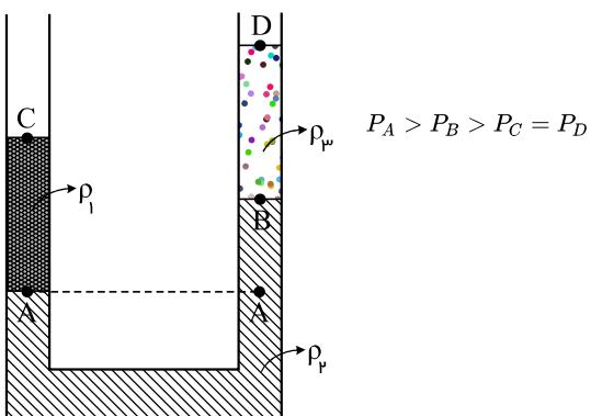
با توجه به شکل، فشار نقاط  $C$  و  $D$  با فشار هوای محیط برابر است، یعنی  $P_C = P_D = P_0$  از طرفی فشار نقطه  $B$  بیشتر از نقطه  $D$  است و با توجه به شکل، فشار نقطه  $A$  نیز بیشتر از  $B$  است؛ بنابراین داریم:
