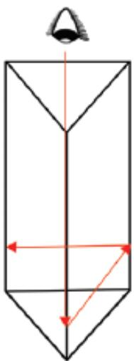
**پریسکوپ:** چشم زیردریایی هم گفته می‌شود و در جایی که بخواهیم چیزی هم سطح با ما نیست یا مانعی برای دیدن آن در مقابل ما وجود دارد از پریسکوپ استفاده می‌شود.
