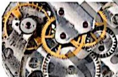
**الف) چرخ دنده‌ها:** چرخ دنده‌ها بیشتر در ساعت‌سازی، ماشین‌آلات صنعتی، دوچرخه و ... استفاده می‌شوند. اگر نیرو به چرخ بزرگ وارد شود و چرخ کوچک را بچرخاند، حتماً ماشین افزایش سرعت و جبهه‌جایی خواهد داشت. اگر نیرو به چرخ کوچک وارد شود، ماشین افزایش نیرو می‌یابد ولی در هر دو صورت حتماً تغییر جهت نیرو صورت می‌گیرد.
