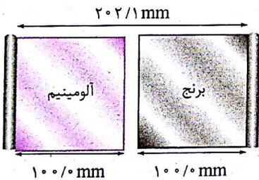
$$\left( \alpha_{\text{آلومینیم}} = 23 \times 10^{-6} \text{ } 1/\text{K}, \alpha_{\text{برنج}} = 19 \times 10^{-6} \text{ } 1/\text{K} \right)$$
