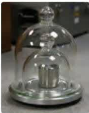
شکل ۱-۷ استاندارد ملی کیلوگرم که نسخه دقیق‌تری از استاندارد بین‌المللی سور فرانسه است. این نمونه، در مرکز اندازه‌سناسی در سازمان ملی استاندارد ایران نگهداری می‌شود.
