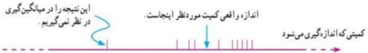
شکل ۱-۹ نتایج اندازه‌گیری شده حول اندازه واقعی. هر نشانه قرمز رنگ، نشان‌دهنده نتیجه یک اندازه‌گیری است.
