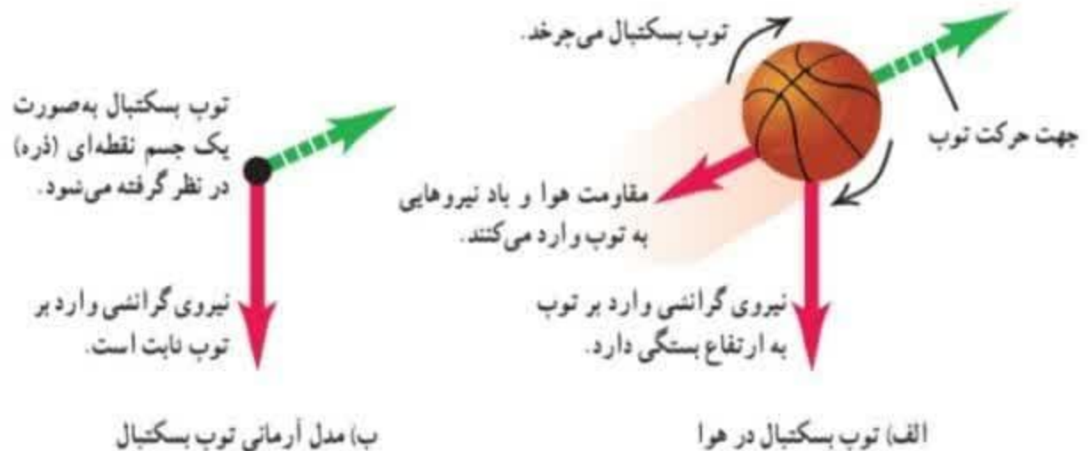
شکل ۱-۳ استفاده از یک مدل آرمانی برای ساده‌سازی تحلیل حرکت یک توپ بسکتبال در هوا
