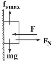
$F_{\text{nety}} = ma \xrightarrow{a=0} mg - f_{s\text{max}} = 0 \Rightarrow f_{s\text{max}} = 4 \times 10 = 40 \text{ N} \text{ (نمره ۰/۵)}$ $f_{s\text{max}} = \mu_s F_N \xrightarrow{F_N=F} 40 = 0.5 \times F_N \Rightarrow F_N = 80 \text{ N} \Rightarrow F_N = F = 80 \text{ N} \text{ (نمره ۰/۵)}$ |                        | ۱۲<br>از طرفی:<br>(فصل دوم - دینامیک) (متوسط)                                                                                                                         |
