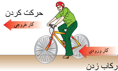
شکل ۱- کار انجام شده توسط نیروی پا به انرژی جنبشی تبدیل می شود.
