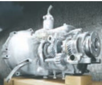
شکل ۱۵ - ترکیب پیچیده ای از چرخ دنده در جعبه دنده خودرو
