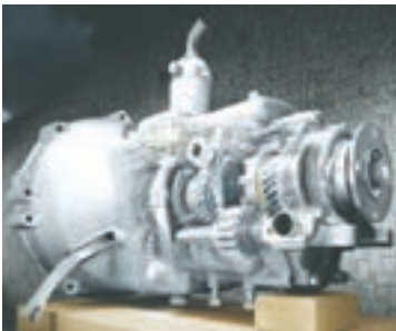
شکل ۱۵ - ترکیب پیچیده‌ای از چرخ‌دنده در جعبه‌دنده خودرو
