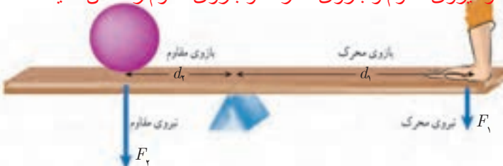
شکل ۱۱ - شکل اهرم که در آن بازوی محرک، نیروی محرک، بازوی مقاوم و نیروی مقاوم نشان داده شده است.
