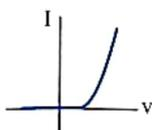
(ب) مقاومت اهمی از قانون اهم پیروی می‌کند و رابطه جریان و ولتاژ به صورت خطی می‌باشد در حالی که در مقاومت غیراهمی رابطه جریان و ولتاژ به صورت خطی نمی‌باشد.
