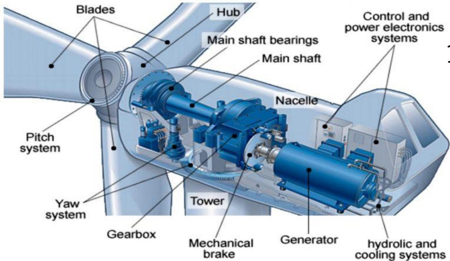
. توربین بادی وسیله‌ای است که انرژی جنبشی موجود در باد را به انرژی الکتریکی تبدیل می‌نماید. فرآیند تبدیل انرژی عبارت است از تبدیل انرژی جنبشی باد به انرژی جنبشی مجموعه روتور و سپس تبدیل آن به انرژی الکتریکی در ژنراتور است. امروزه بیشترین توربین‌های بادی، توربین‌هایی با محور افقی می‌باشند که در این قسمت اجزا این توربین‌ها معرفی می‌شوند. منظور از عبارت "محور افقی" این است که محور اصلی توربین بادی که نیرو محركه را تولید می‌کند افقی است.
