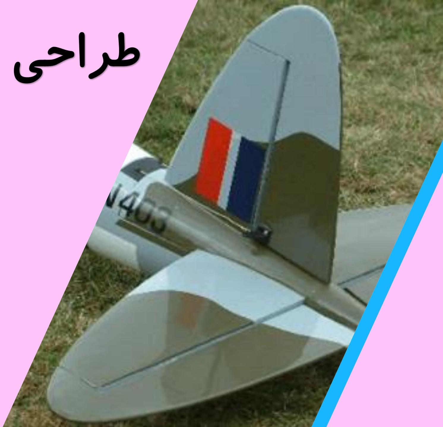
دم پرنده برای تعادل پرواز است و نیرویی رو به پایین تولید می‌کند. برای جلوگیری از کاهش نیروی لیفت و به پایین کشیده شدن پرنده، دم باید تا جای ممکن کوچک و نازک باشد تا نیروی رو به پایین و نیروی درگ کمتری تولید کند.
