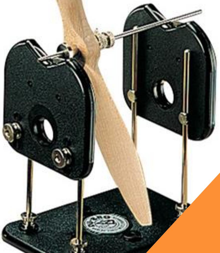
بسیاری از ملخ‌ها، بخصوص نمونه‌های دست ساز و چوبی نیاز به بالانس کردن دارند که این کار را با استفاده از دستگاه رو به رو و ساییدن ملخ انجام می‌دهند.
