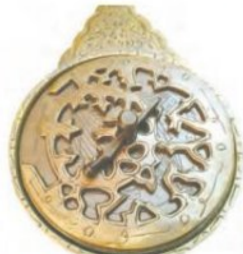
شکل ۱- الف) اسطرلاب، ب) نحوه رصد ستاره به وسیله اسطرلاب
