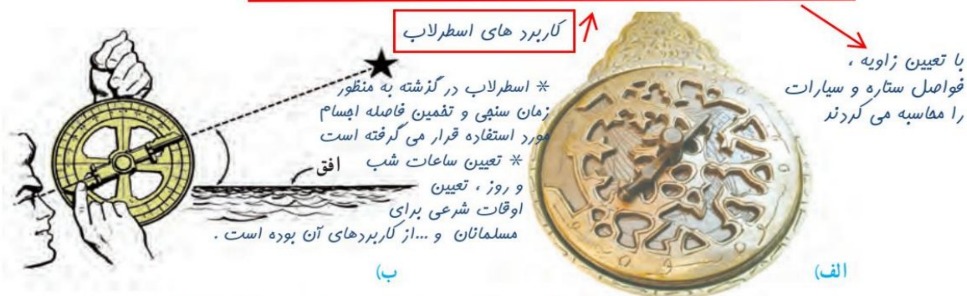
شکل ۱- الف) اسطرلاب، ب) نحوه رصد ستاره به وسیله اسطرلاب
