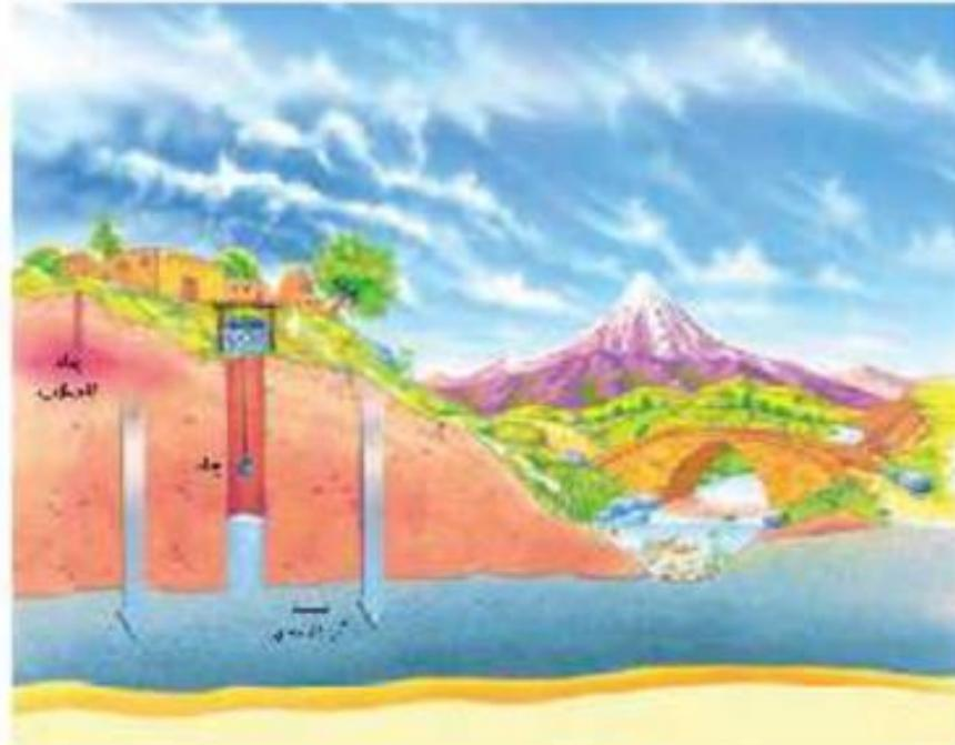
**قنات:** مجموعه‌ای از چند چاه است که چاه اصلی (چاه مادر) به آب زیرزمینی می‌رسد و بعد مابا تونل زدن زمین، آب را به چاه‌های دیگر هدایت می‌کنیم تا بتوانیم برای کشاورزی و آشامیدن از آن استفاده کنیم.
